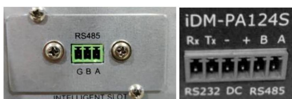
Placa RS485 instalada no slot inteligente
