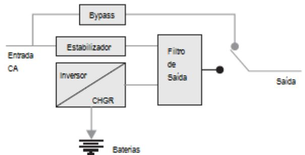
7.1.3 - Após a inicialização, em condições normais de operação, a carga será alimentada através do estabilizador de tensão conforme figura a seguir (LED Bypass apagado / LED verde ligado. As baterias internas serão mantidas carregadas.
