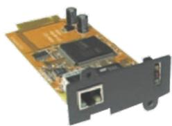
A placa SNMP, permite conexão remota com o nobreak, sem a necessidade de instalação de software. O acesso é simples e feito por qualquer browser bastando digitar o endereço IP correspondente.
